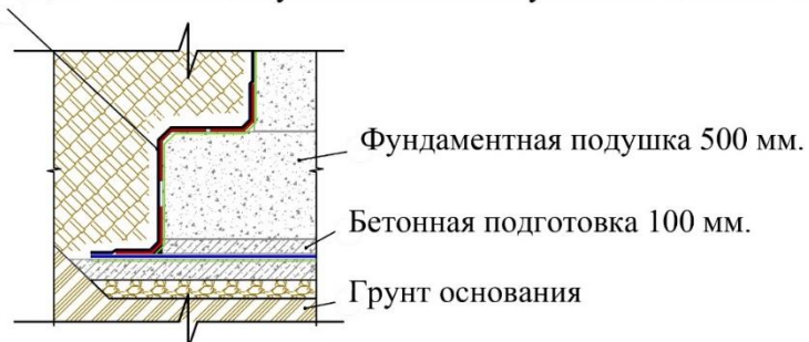
Рисунок 31. Узел примыкания колонны к фундаменту
